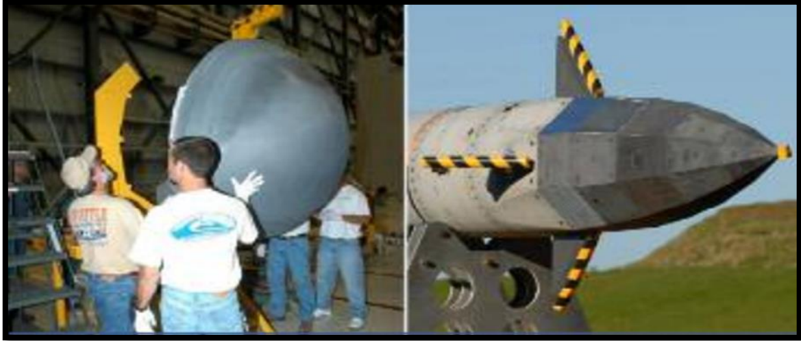
Şekil 2. Küt ve keskin burun konisi ile hücum kenarı (Tülbez ve ark., 2019).
