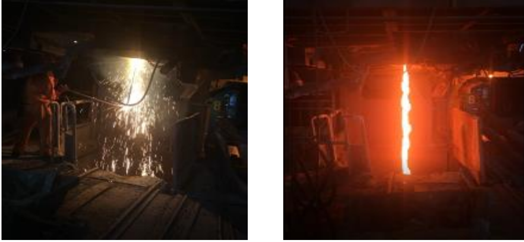
Şekil 17. Kupola fırınında yapılan demir alma işlemi
