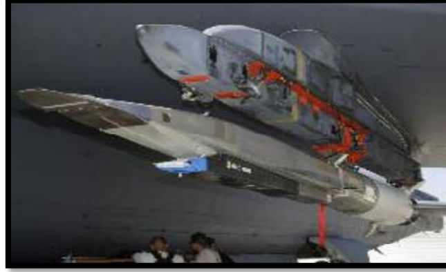
Şekil 1. B-52 kanadına monte edilen X-51 uçuş aracı (Tülbez ve ark., 2019).
