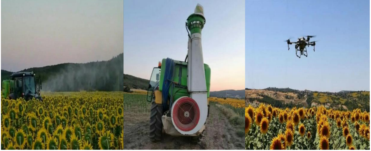
Şekil 1. Pülverizatör, atomizör ve drone ile kimyasal mücadele uygulamaları
