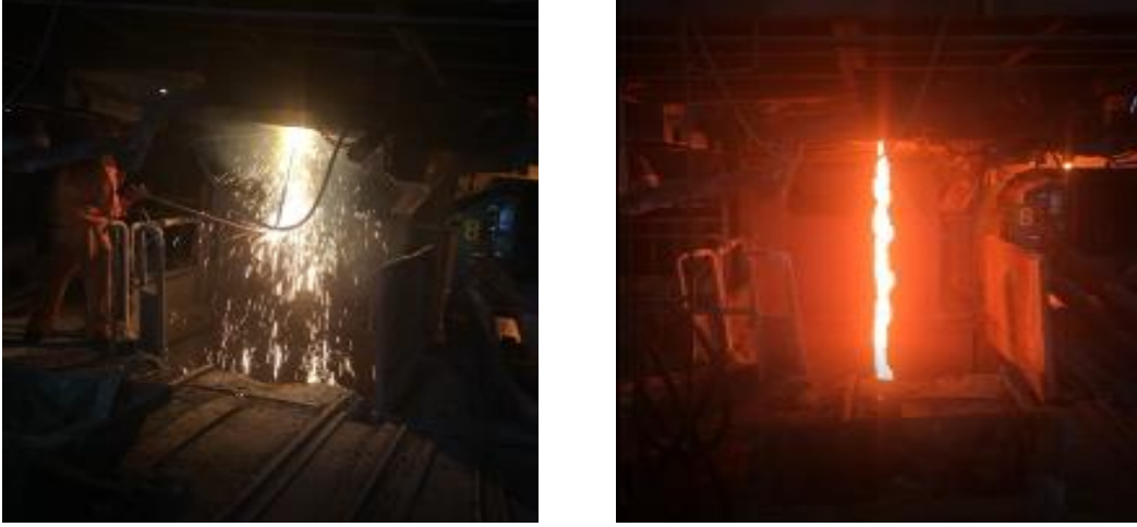
Şekil 17. Kupola fırınında yapılan demir alma işlemi
