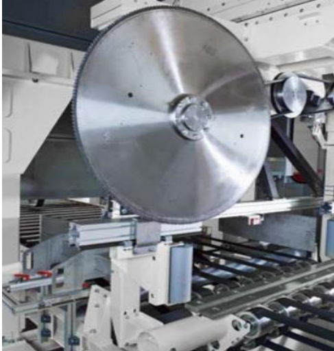
Şekil 12. Testere hattı / Dikey kesim ünitesi
