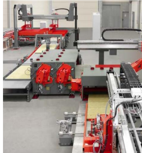
Şekil 12. Testere hattı / Dikey kesim ünitesi
